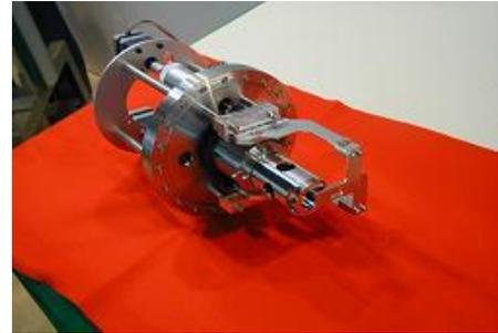
本ユニットは、半導体レーザー制御・電源モジュールから赤外線レーザー光を取り出し、光ファイバーを通して真空装置上部からレーザー光をレンズによる適度な収束の後基板裏面に照射することで、高真空中で無負荷状態の基板を最高到達温度1200℃まで加熱可能なユニットです。
