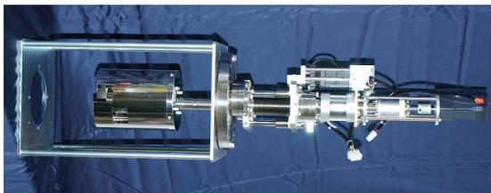
ターゲットの自転およびターゲット選択のための公転などの機構を持つユニットです。本ユニットは、種類の違うターゲット材料を最大6種類入れることができ、コンタミネーション防止シールドにより、コンタミネーションの心配がありません。
