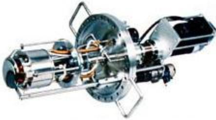
本ユニットは、超高真空対応型赤外放射ランプを使用した基板回転加熱機構であり、超高真空雰囲気において基板を800℃以上に上げる事が可能となっています。プロセスガス 特に酸素中でも加熱でき、構造上酸化しにくくなっています。
