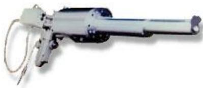
活性原子 / ラジカルビーム源は水素、窒素、酸素などのガスを導入口とRF放電によりラジカルを形成する分解室 及び 基板に照射する噴出口から形成されています。
